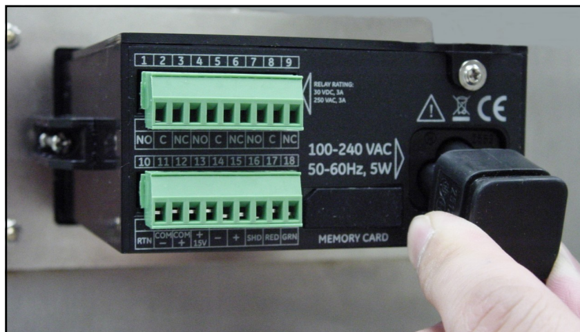
Рис. 38: Подключение кабеля питания сети переменного тока
