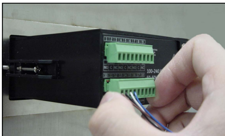
Рис. 36: Повторное подключение разъема в клеммный блок
