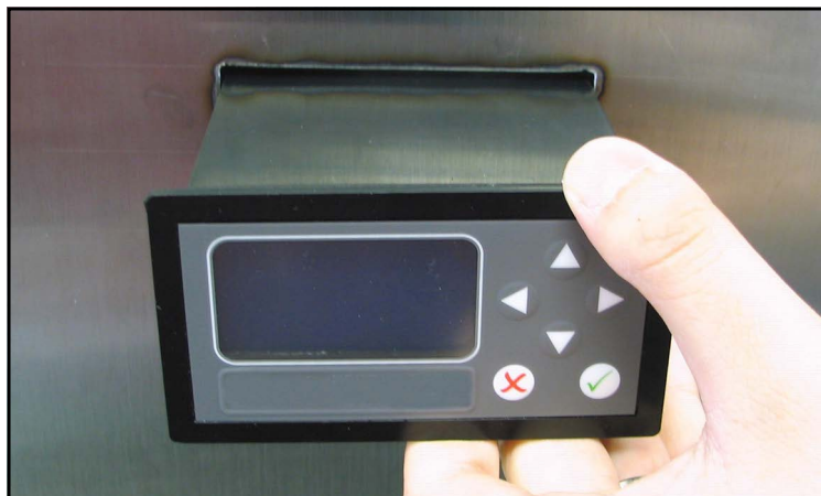
Рис. 11: Сдвиг одноканального гигрометра в вырез панели
