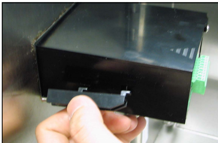
Рис. 12: Установка монтажных кронштейнов
