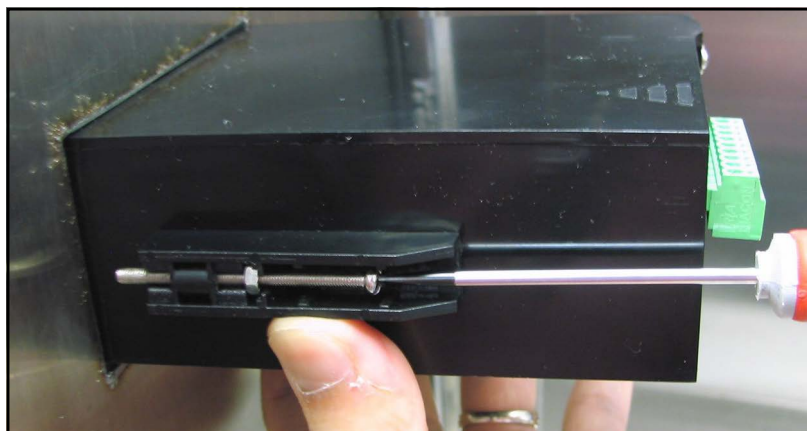
Рис. 14: Крепление одноканального гигрометра к панели
