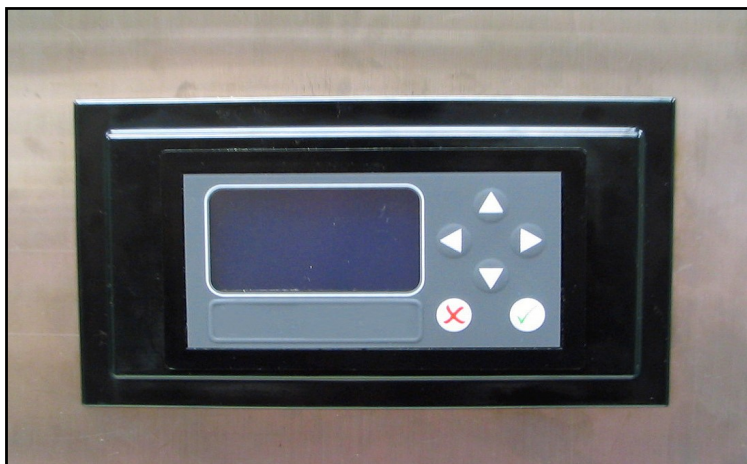
Рис. 22: Установка гигрометра с переходной пластиной - Вид спереди
