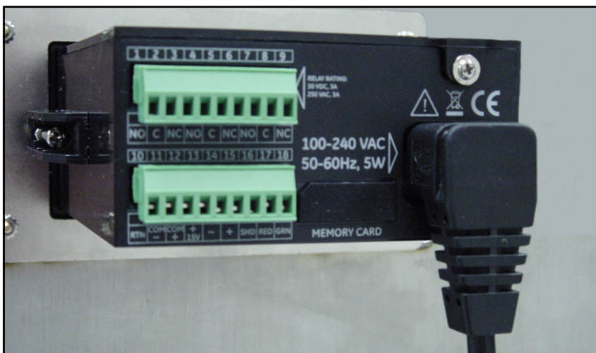
Рис. 39: Кабель питания от сети переменного тока подключен
