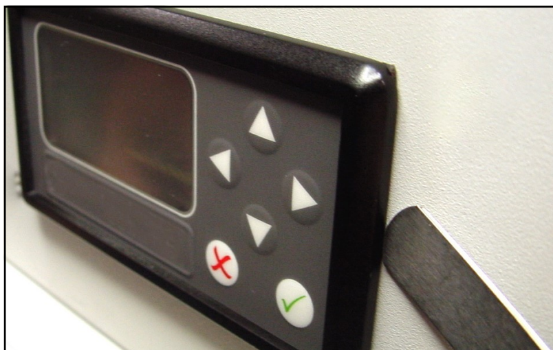
Рис. 15: Проверка сжатия прокладки
