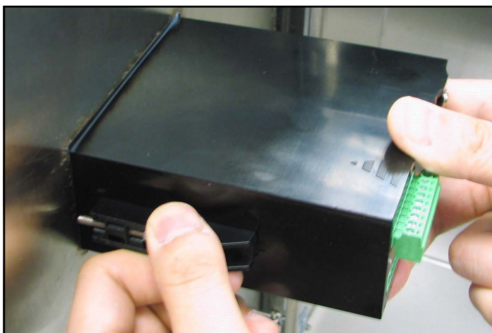
Рис. 13: Фиксация монтажных кронштейнов на месте
