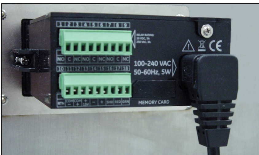
Figura 39: O cabo de força CA instalado
