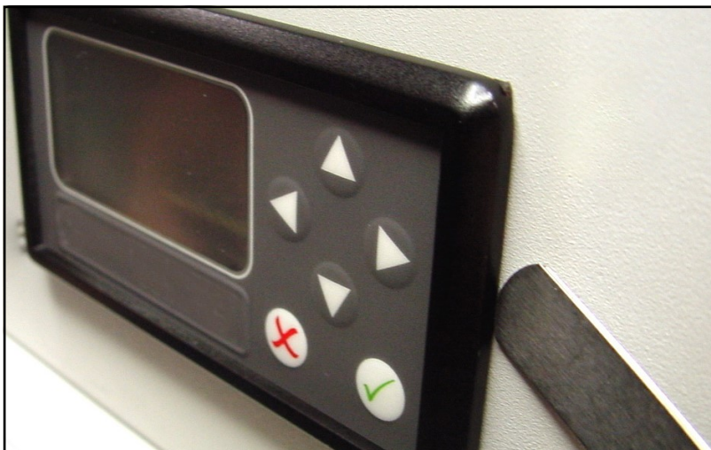
Figura 15: Verificar a compactação da gaxeta
