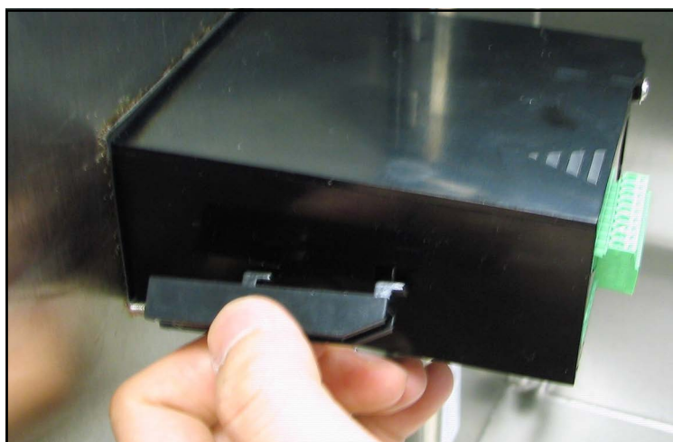
Figura 12: Instalar os suportes de montagem
