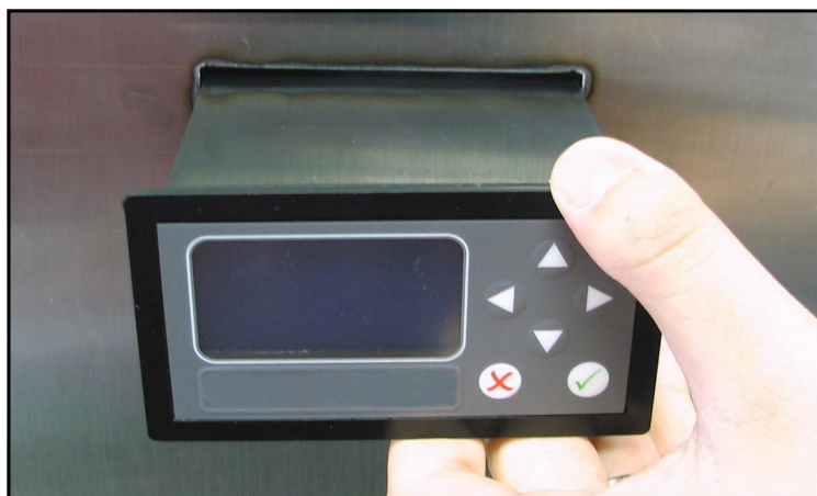
Figura 11: Deslize o higrômetro no corte do painel.
