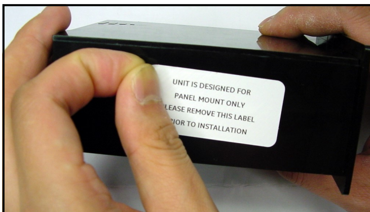
Figura 9: Remover a etiqueta de montagem no painel lateral
