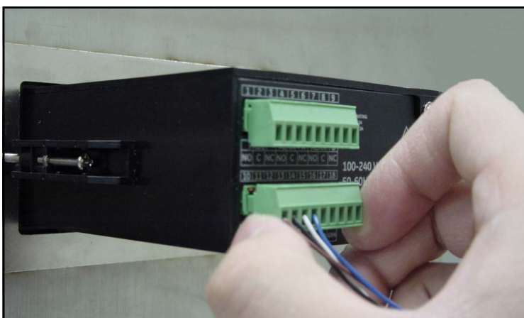
Figura 36: Reinserir o conector no bloco terminal
