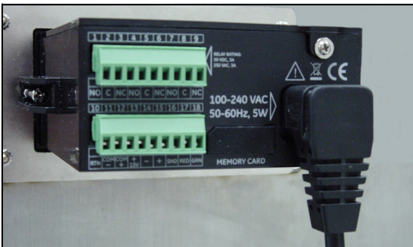
Figura 39: Cavo di alimentazione CA installato
