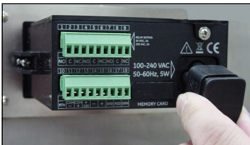
Figure 38: Branchement du câble d'alimentation CA
