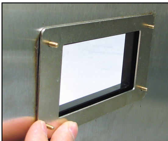
Figure 18: Pose de la plaque d'appui
