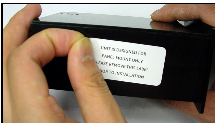
Figure 9: Retrait de l'étiquette de montage sur le panneau latéral
