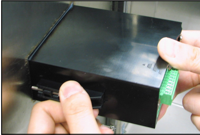
Figure 13: Blocage des supports de fixation en place
