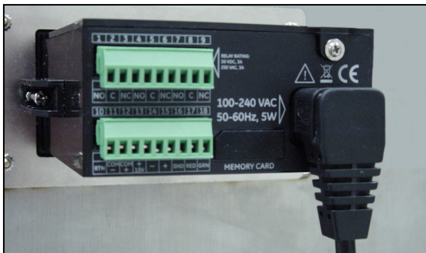
Figure 39: Câble d'alimentation CA branché
