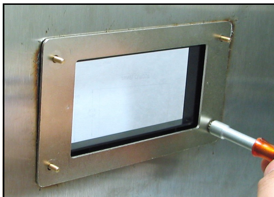
Figure 19: Fixation de l'ensemble au panneau
