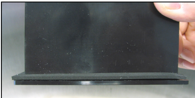
Figure 10: Pose du joint sur la face arrière de l'afficheur
