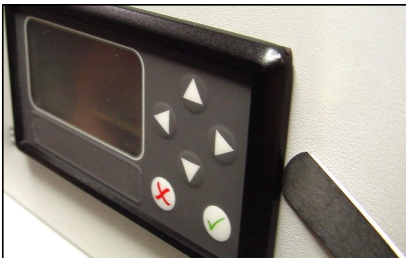
Figure 15: Vérification de la compression du joint
