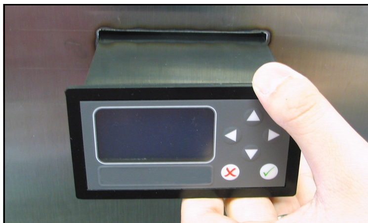
Figure 11: Insertion de l'hygromètre dans la découpe du panneau
