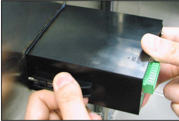
Figura 13: Bloqueo del soporte de montaje en su sitio
