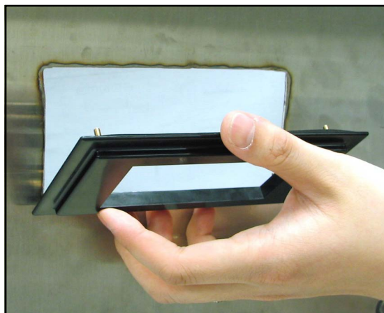
Figura 17: Inserción de la placa adaptadora
