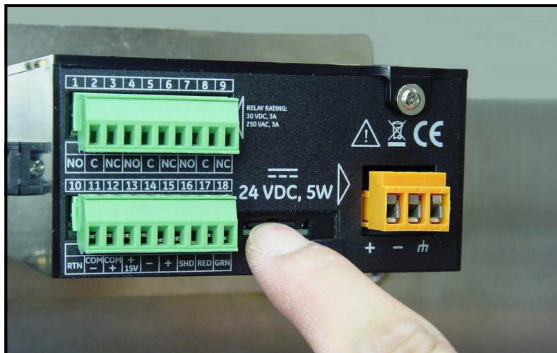
Figura 53: Empuje de la tarjeta MicroSD
