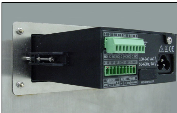
Figura 34: Conector inferior extraído
