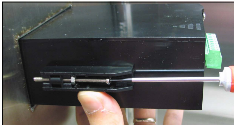
Figura 14: Fijación del higrómetro monocanal al panel
