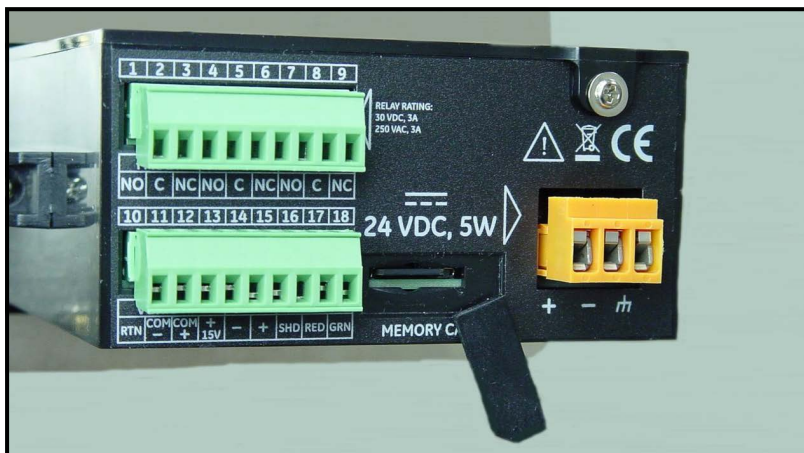
Figura 52: Alojamiento de la tarjeta de memoria abierto
