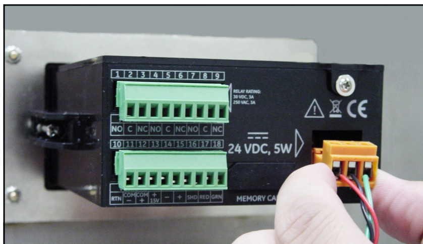
Figura 42: Reinserción del conector de CC
