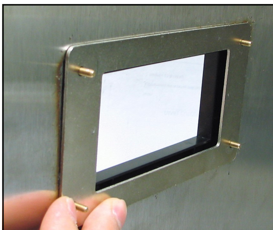
Figura 18: Colocación de la placa de apoyo
