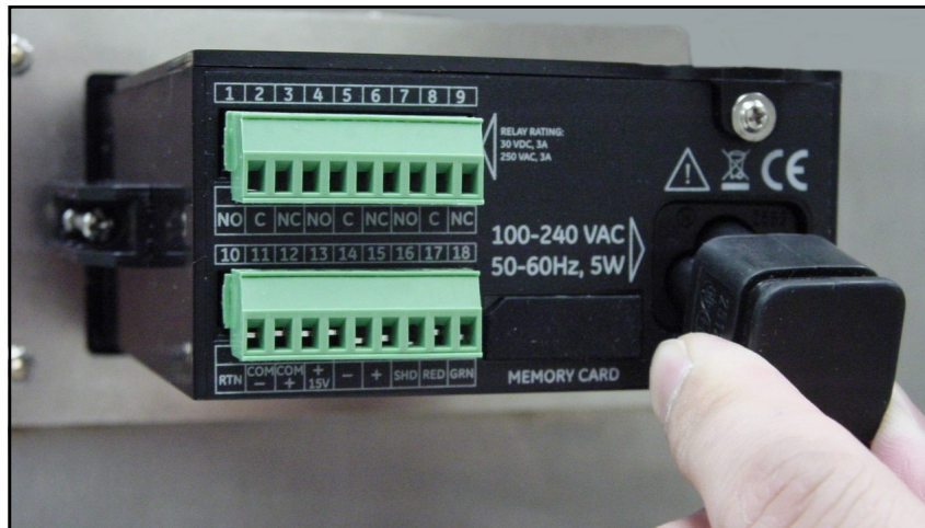
Figura 38: Conexión del cable de alimentación de CA
