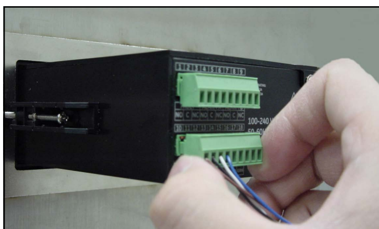
Figura 36: Reinserción del conector en el bloque de terminales
