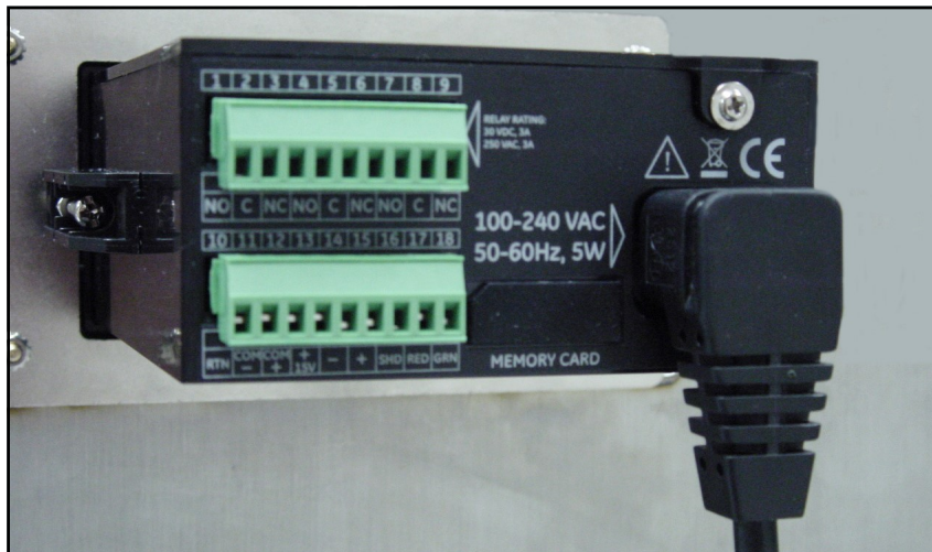
Figura 39: Cable de alimentación de CA instalado
