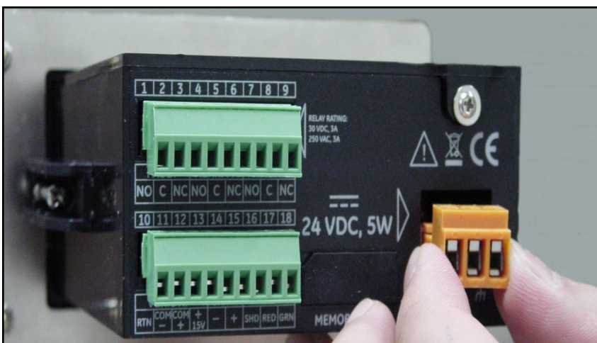
Figura 41: Extracción del conector de CC
