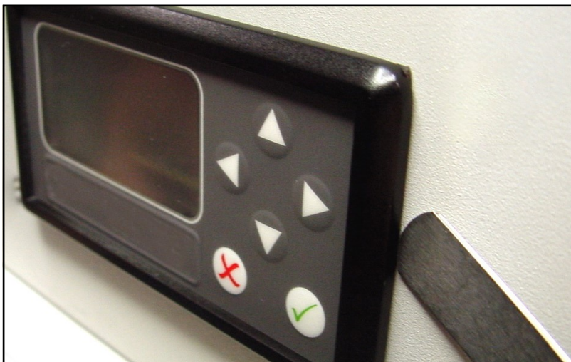
Figura 15: Comprobación de la compresión de la junta
