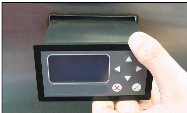
Figura 11: Deslizamiento del higrómetro por el orificio del panel
