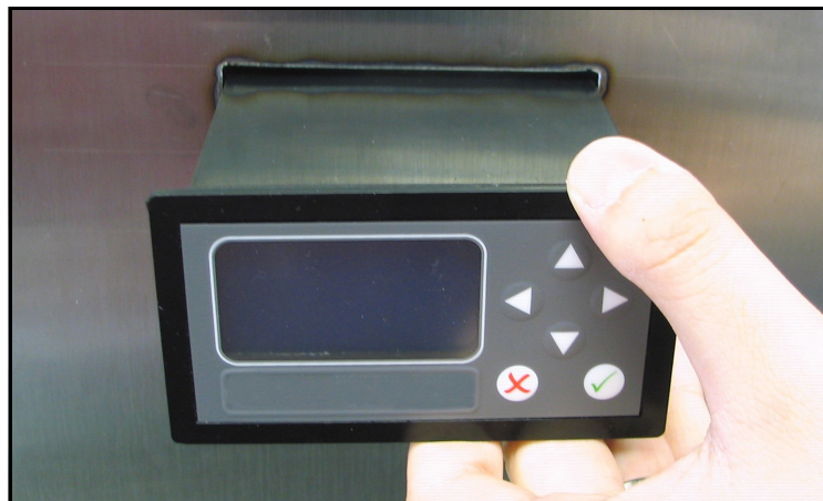
Abbildung 11: Schieben des Hygrometers in den Tafelausschnitt
