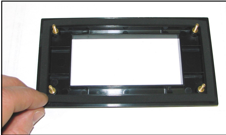
Abbildung 16: Anbringen der Adapterplattendichtung
