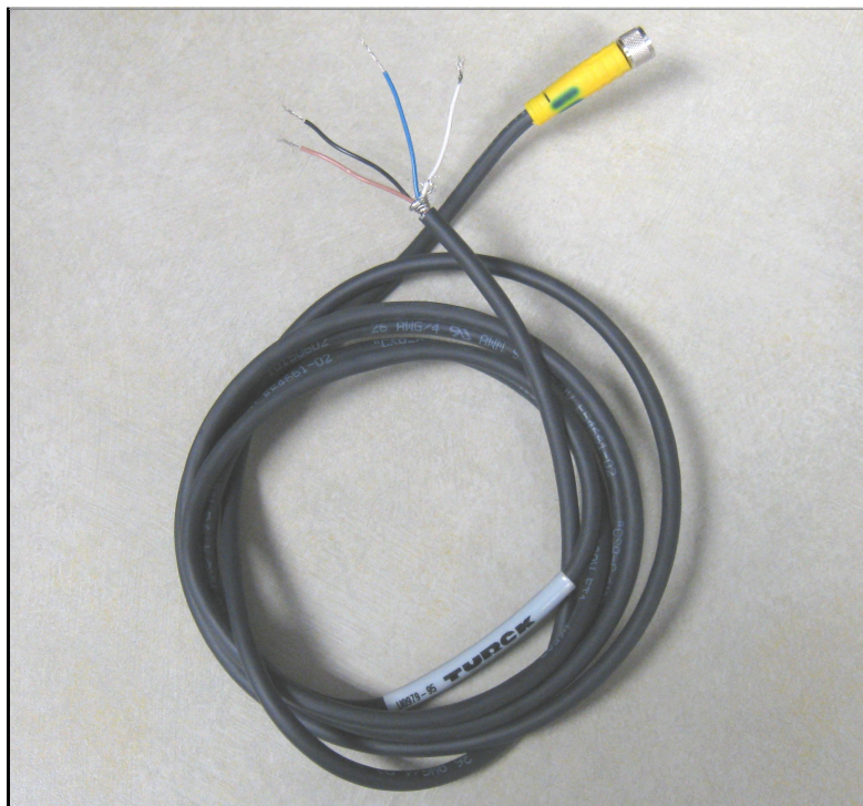
Abbildung 33: Kabel des Feuchtigkeits-Messwandlers
