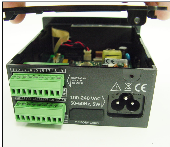
Abbildung 7: Abheben der Abdeckung
