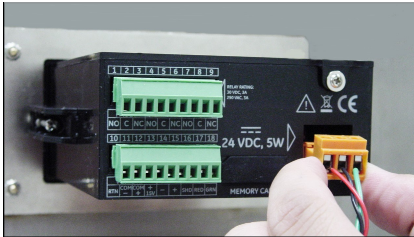
Abbildung 42: Wiederanschießen des Gleichstromsteckers
