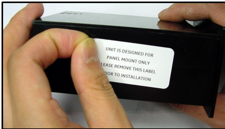
Abbildung 9: Entfernen des seitlichen Aufklebers für die Tafelmontage
