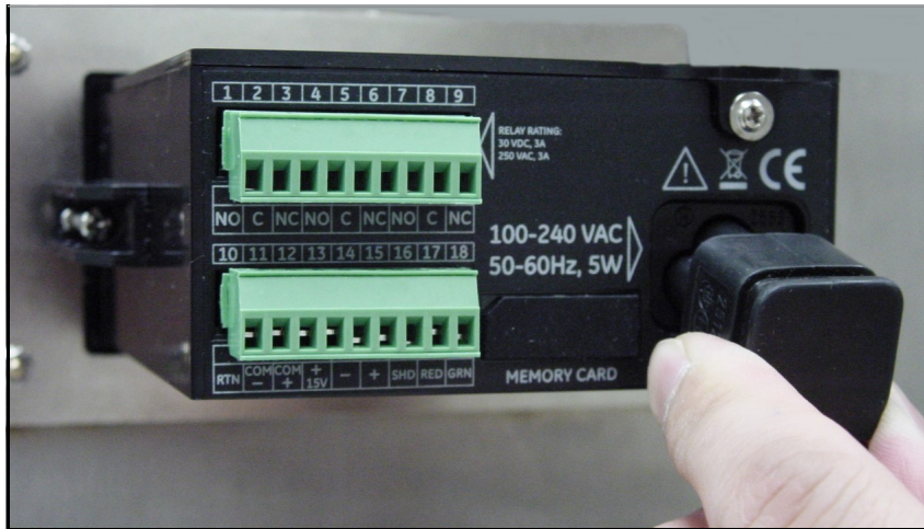
Abbildung 38: Anschließen des Netzkabels
