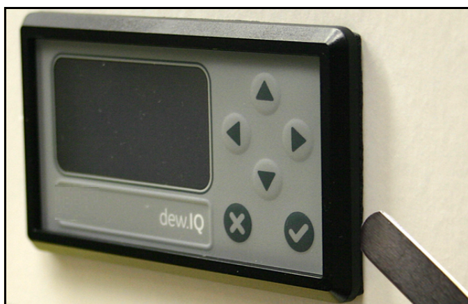
Figura 15: Verificar a compactação da gaxeta
