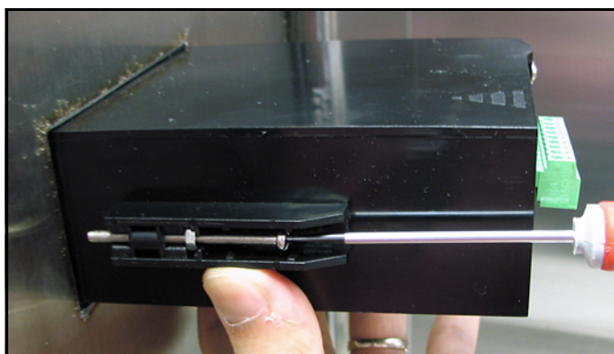
Figura 14: Fixar o dew.IQ ao painel
