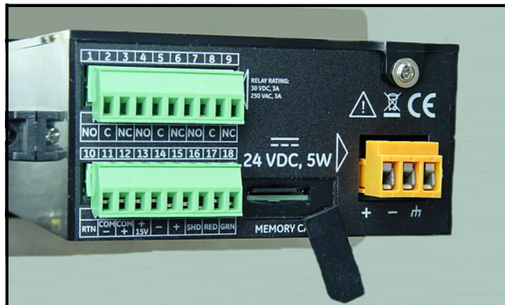
Figura 49: O suporte de placa de memória exposto
