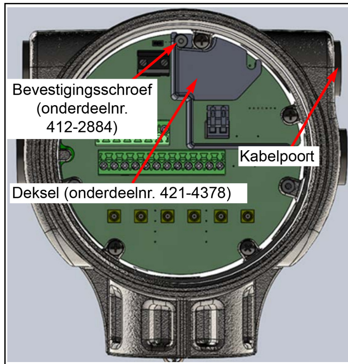
Afbeelding 66: Geïnstalleerde FISCO-afdekking en bevestigingsschroef
