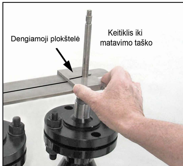
10 pav.: Dengiamosios plokštelės montavimas
