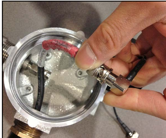
Figura 11: Conexión del conector BNC al cable
