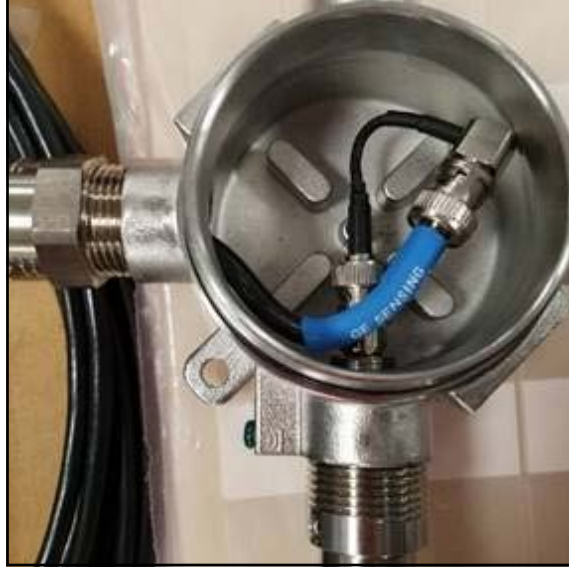
Şekil 17: Kablo Köprülü Dönüştürücü Kablosu Bağlantısı, PN133M7313-03
