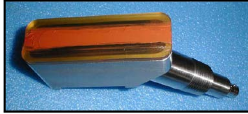
Şekil 25: Dönüştürücü Yüzündeki Bağlantı Maddesi
