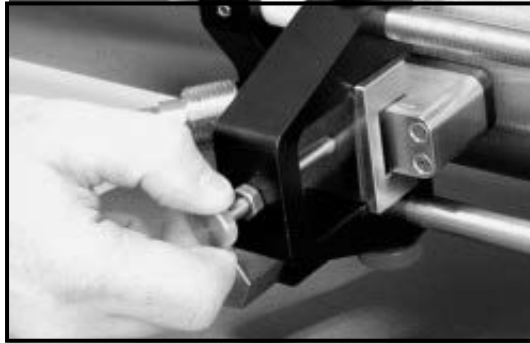
Şekil 26: İlk Dönüştürücünün Takılması
