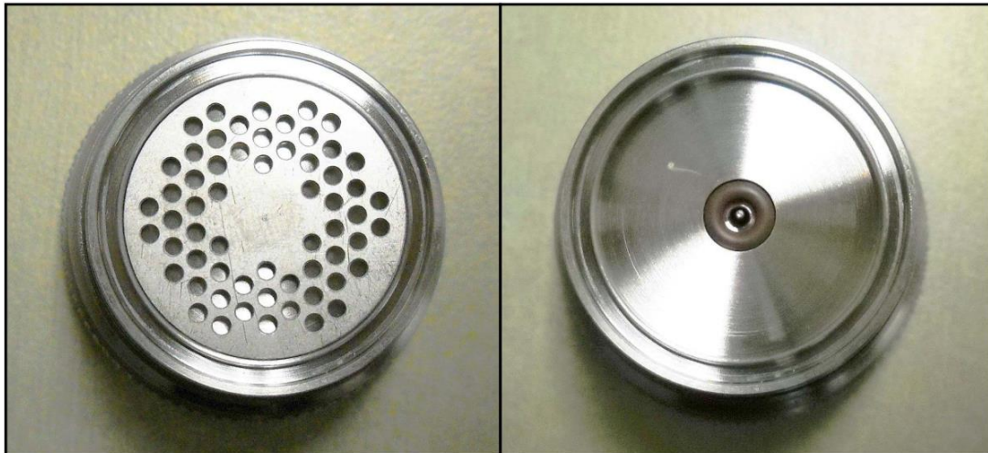
図 64：白いフィルターエレメントと支持プレートの取り外し
