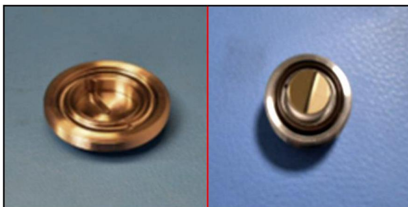
図 58 : エンドキャップアセンブリに洗浄したミラーを戻す
