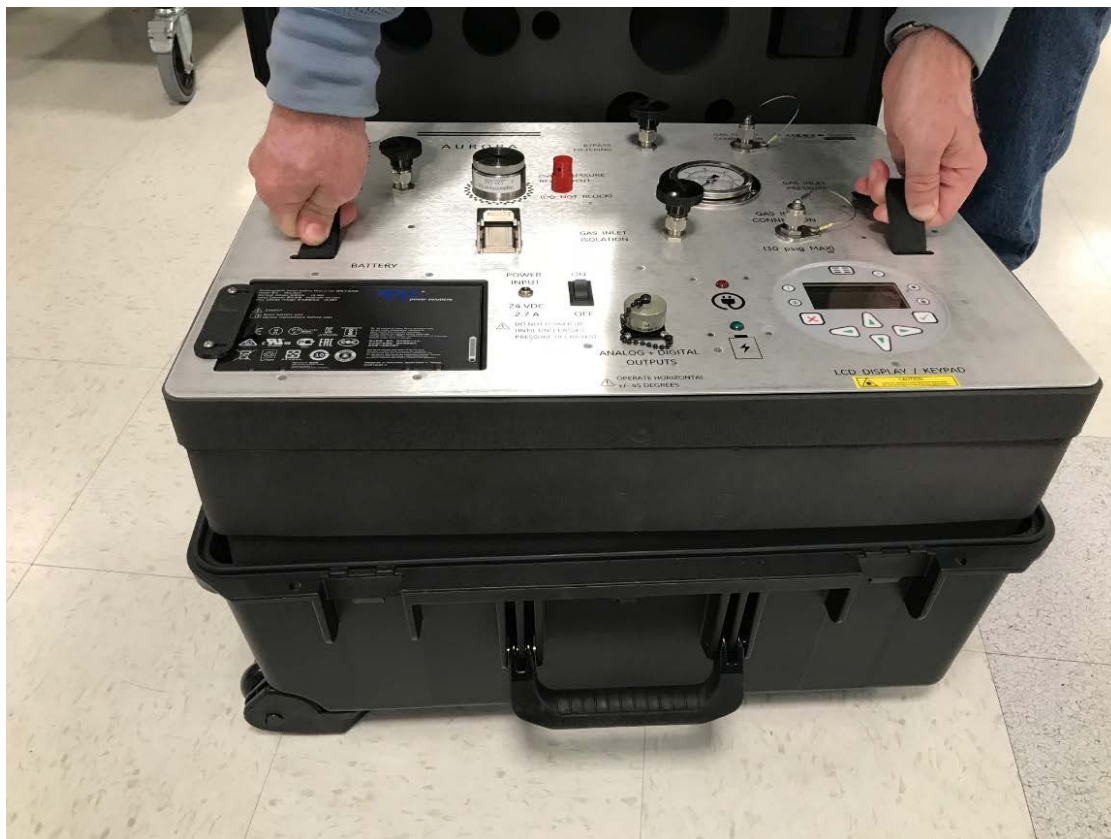
図 60 : ミラー洗浄後、外部ペリカンケースに内部フォームハウジングを戻す
