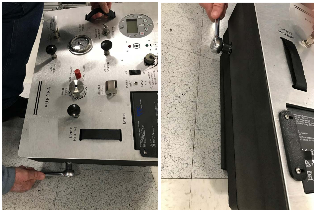
図 53 : ミラー抜け落ち防止のためにアセンブリを上向き保持した状態で、内部フォームハウジングからの吸収セルリアミラー抜き出し
