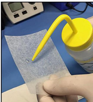
図 56 : レンズ用紙へのアセトンの塗布
