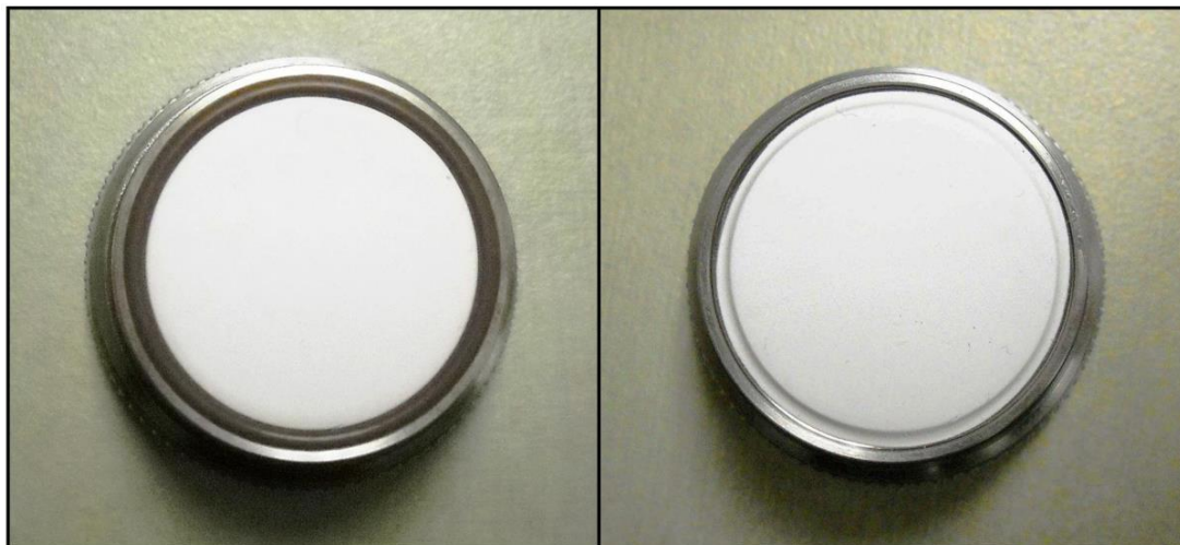
図 63：フィルターキャップの配置と大きい O リングの取り外し
