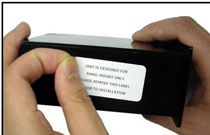
Figura 9: Extracción de la etiqueta de montaje del panel lateral
