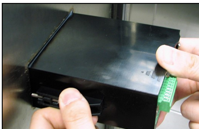
Figura 13: Bloqueo de las ménsulas de montaje en posición
