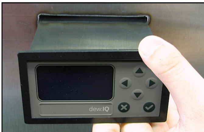
Figura 11: Deslizar el analizador dew.IQ en el corte del panel
