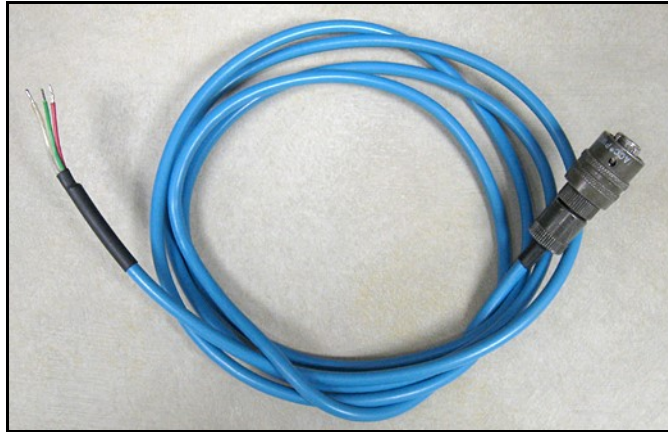
Figura 21: Cable blindado de dos hilos de la sonda M Series
