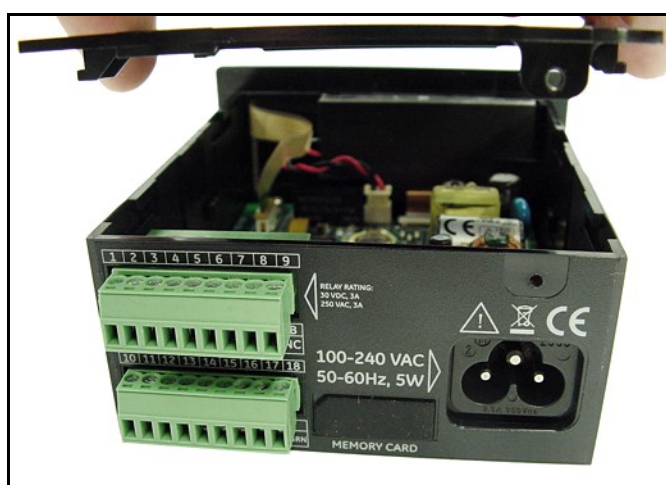
Figura 7: Extracción de la cubierta
