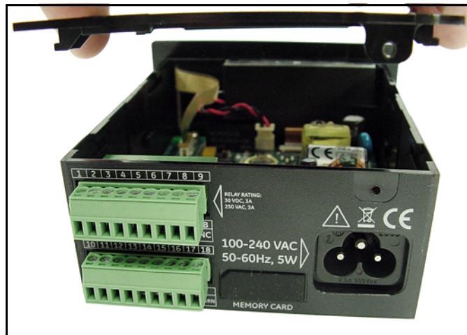
Figure 7: Abnehmen der Abdeckung
