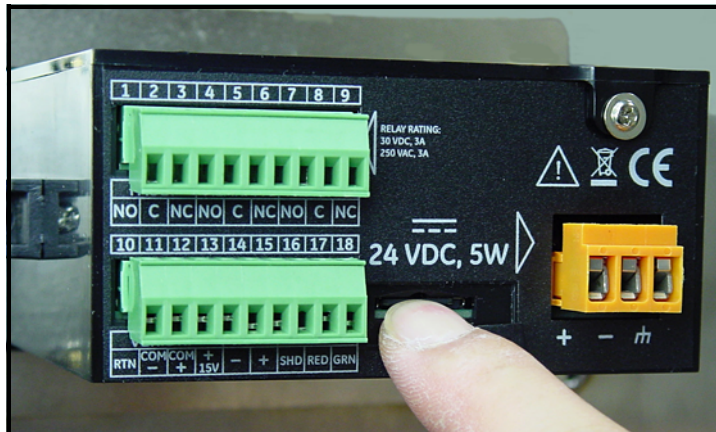
Figure 50: Eindrücken der MicroSD-Karte
