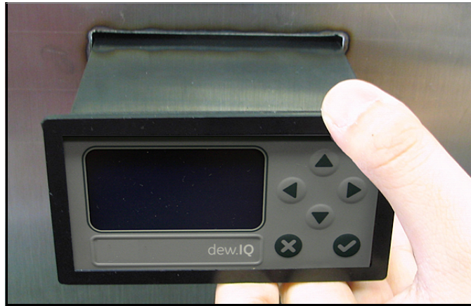
Figure 11: Hineinschieben des dew.IQ in den Tafelausschnitt
