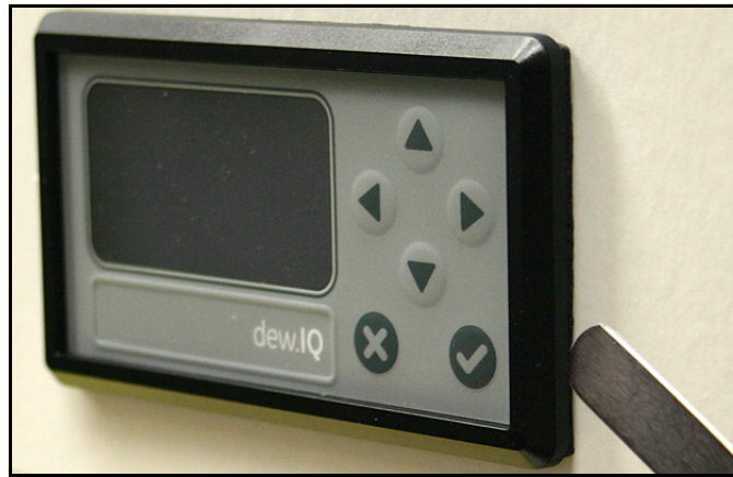
Figure 15: Prüfen des Dichtungsandrucks
