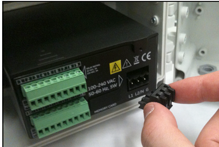
Figure 36: Retrait du connecteur d'alimentation CA
