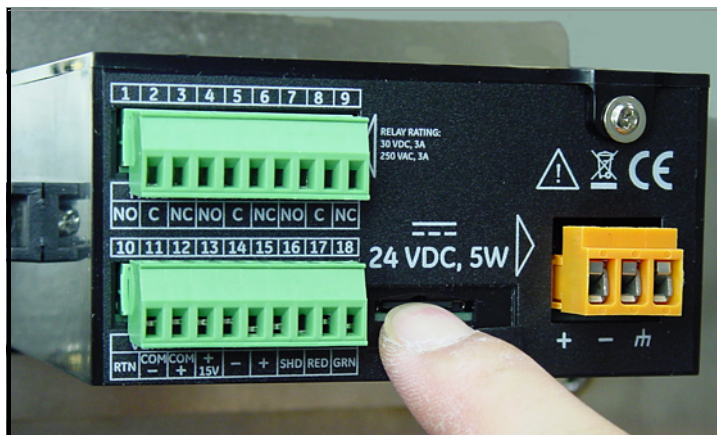
Figure 51: Enfoncement de la carte MicroSD
