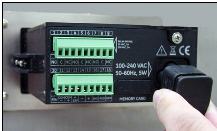
Figure 32: Insertion du câble d'alimentation CA
