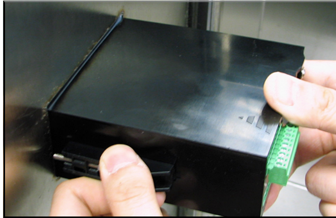
Figure 13: Blocage des supports de fixation en place
