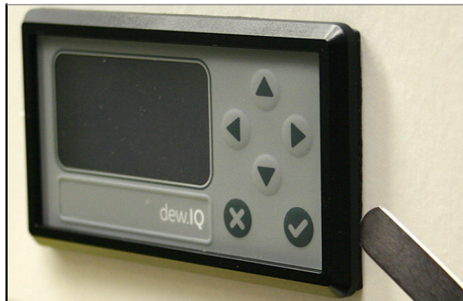
Figure 15: Vérification de la compression du joint
