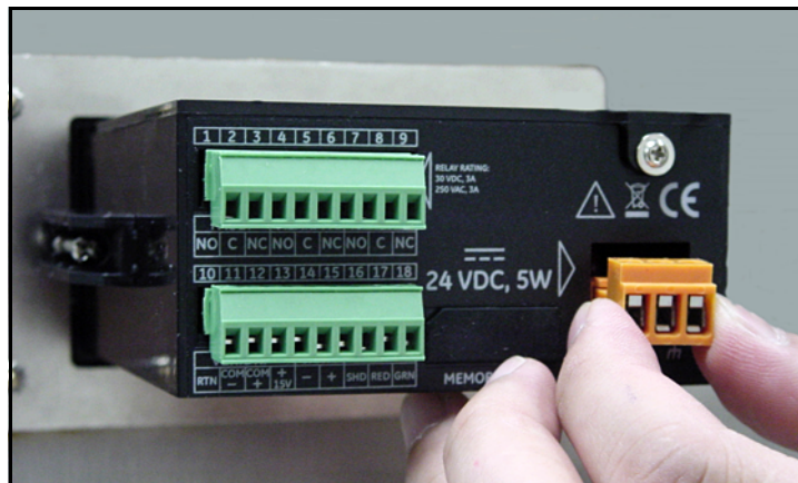
Figure 34: Retrait du connecteur d'alimentation CC
