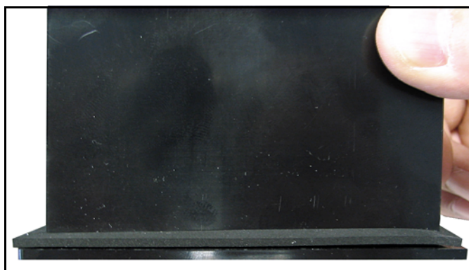
Figure 10: Plaats de pakking achter het scherm
