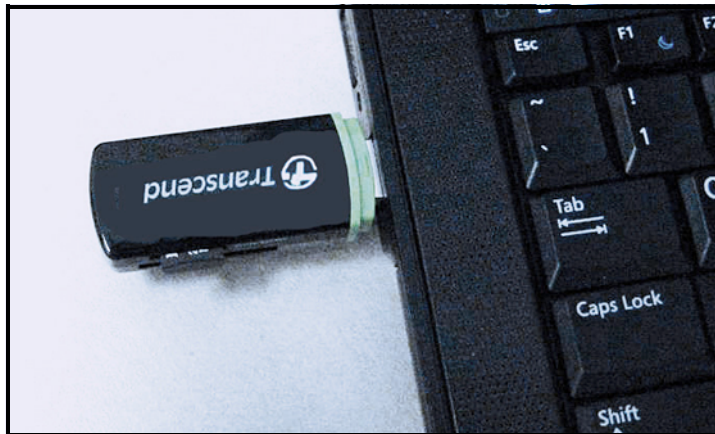
Figure 53: Steek de kaartlezer in een PC
