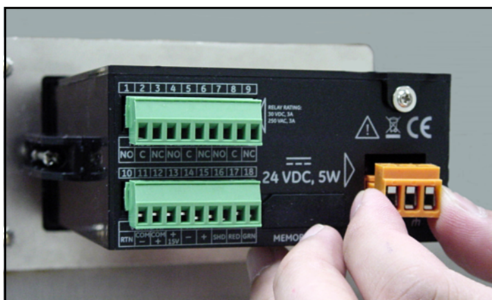
Figure 33: De DC-voedingsaansluiting verwijderen
