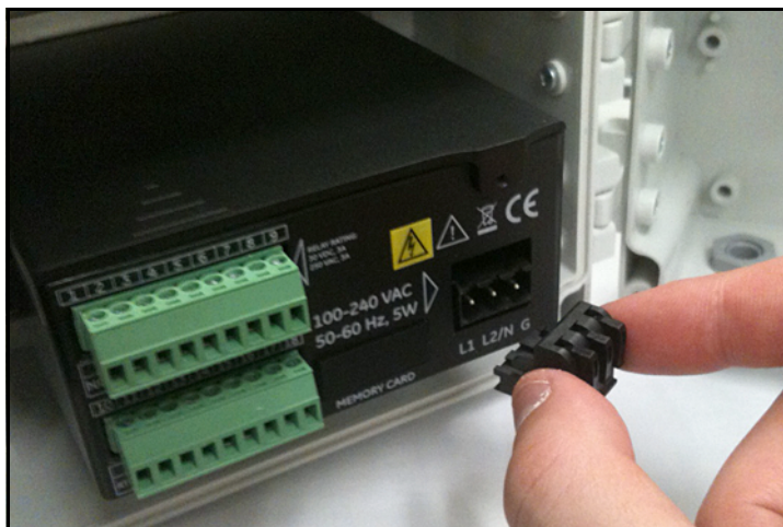
Figure 35: De AC-voedingsaansluiting verwijderen
