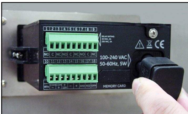
Figure 31: Aanbrengen van het netsnoer
