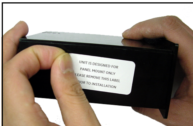
Рисунок 9: Удаление монтажного ярлыка боковой панели
