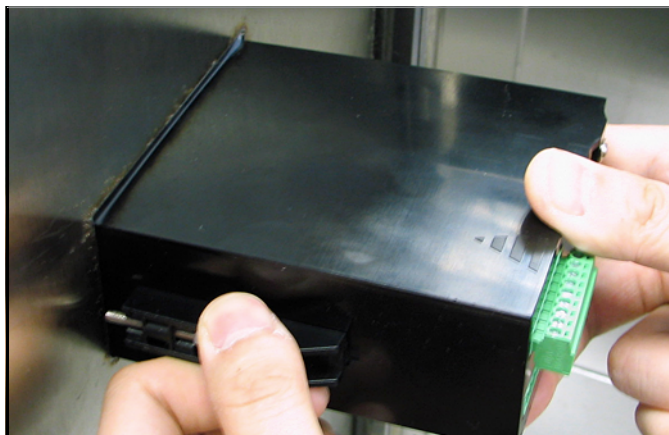
Рисунок 13: Блокировка монтажных кронштейнов на своих местах
