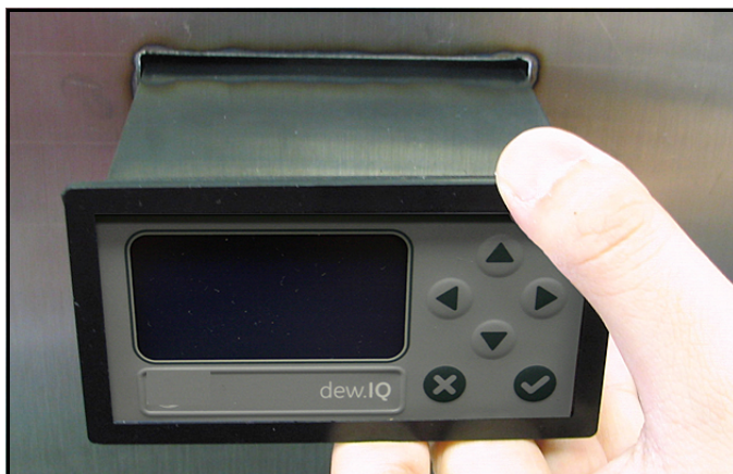
Рисунок 11: Сдвигание прибора dew.IQ в вырез панели
