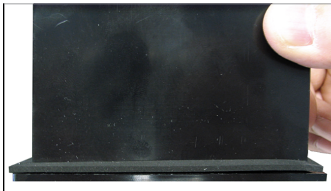
Рисунок 10: Установка прокладки за дисплеем
