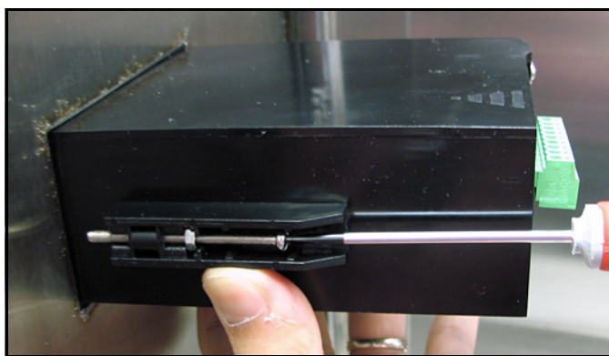
Рисунок 14: Крепление прибора dew.IQ к панели
