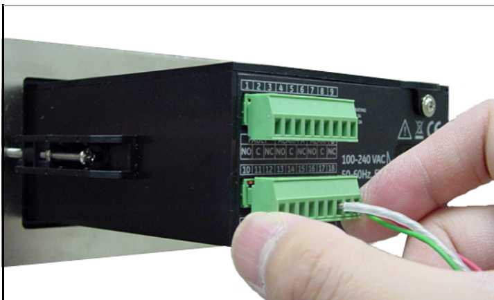
Рисунок 25: Повторная вставка соединителя в клеммную колодку
