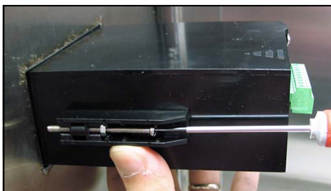
図 14：dew.IQ をパネルに固定する
