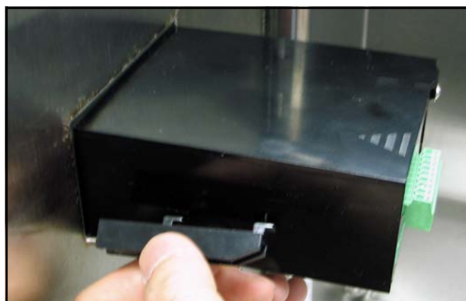
図 12：取り付け金具を設置する
