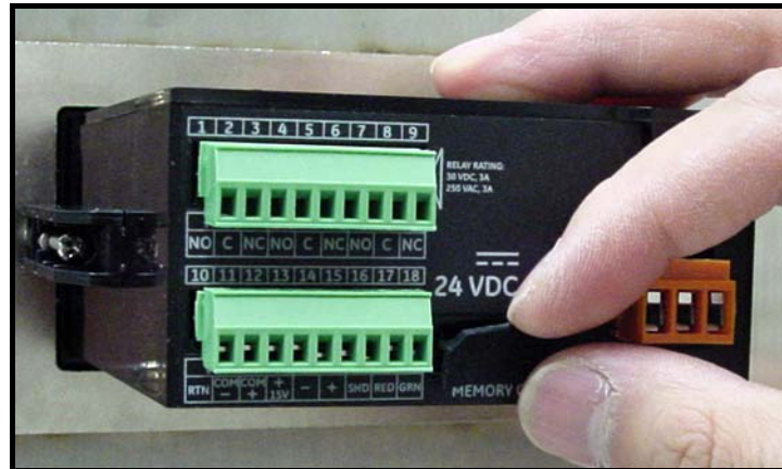
図 48：フレキシブルカバーを引っ張る
