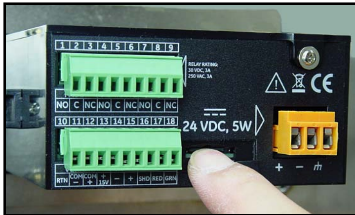
図 50 : マイクロ SD カードを押し込む
