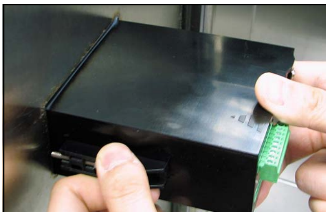
図 13：取り付け金具を所定の位置にロックする
