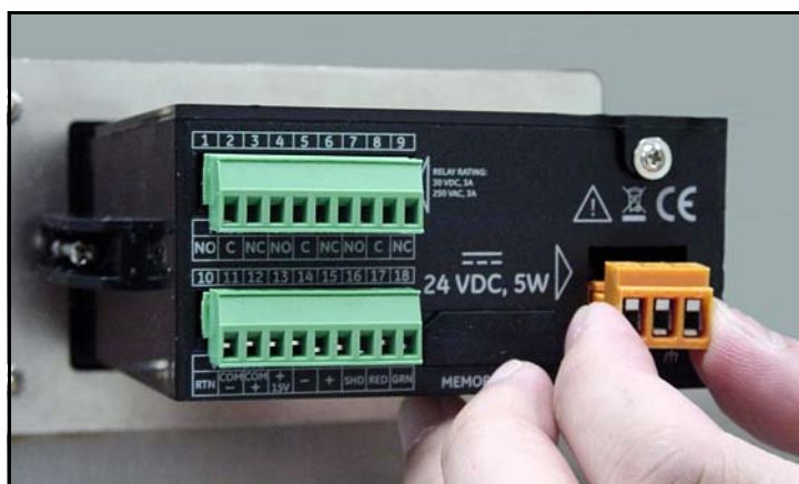
図 33：DC 電源コネクタを外す
