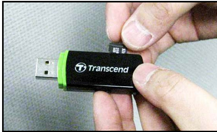
図 52 : マイクロ SD カードをカードリーダーへ差し込む
