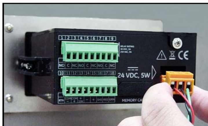
図 34：DC 電源コネクタを再び差し込む
