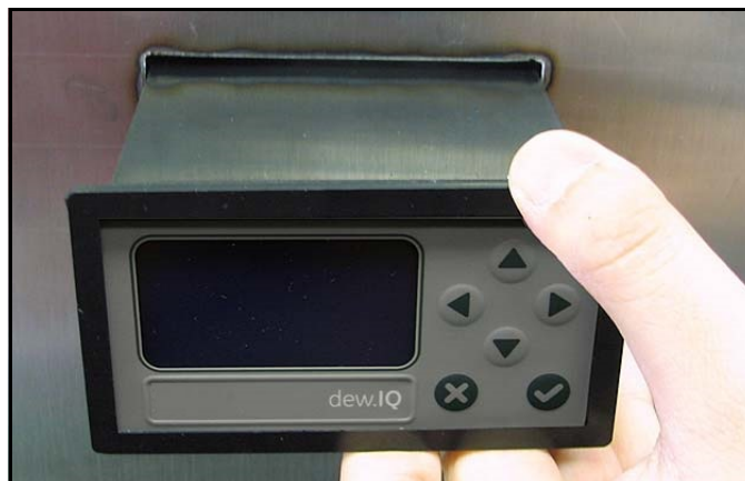
図 11：パネルカットアウト部に dew.IQ をスライドさせて入れる
