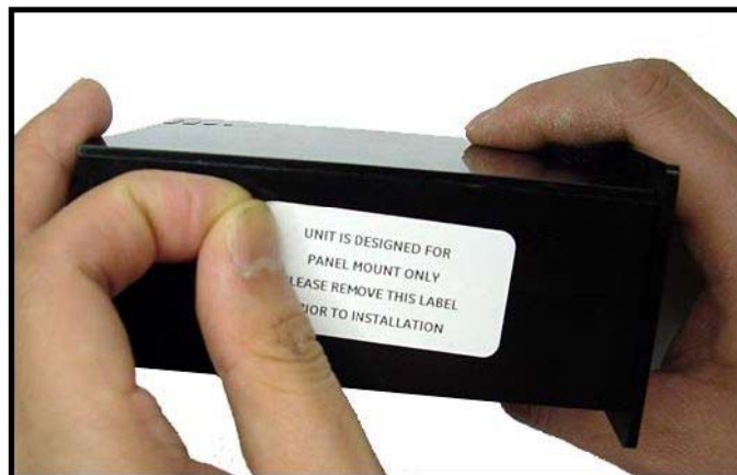
図 9：側面のパネルマウントラベルを外す
