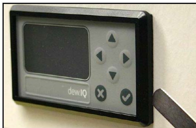
図 15：ガスケットの圧縮を確認する
