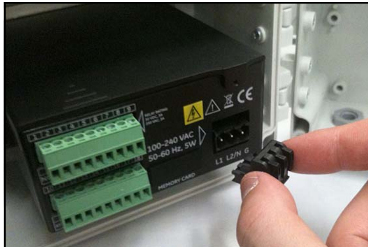
図 35 : AC 電源コネクタを取り外す
