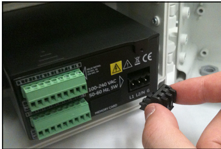
Figure 35: Entfernen des Wechselstromsteckers
