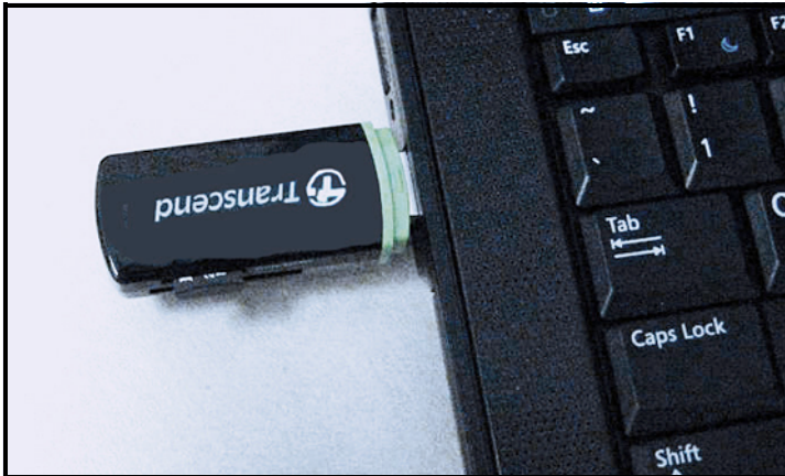
Figure 53: Anschließen des Kartenlesegeräts an einen PC
