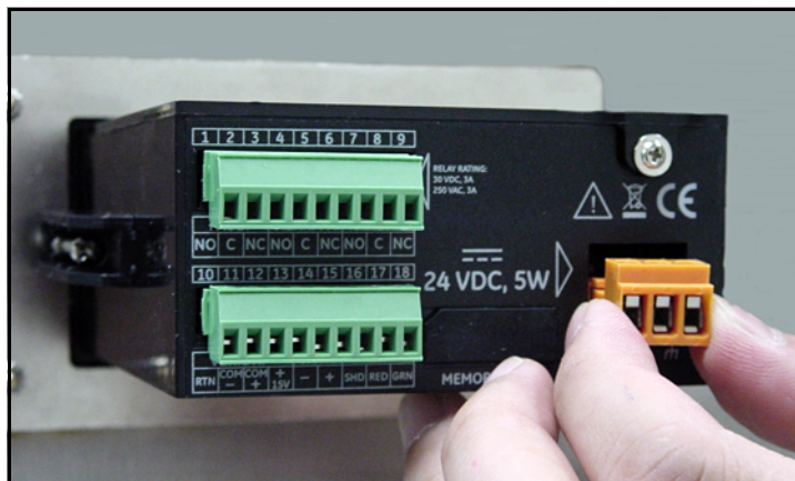
Figure 33: Entfernen des Gleichstromsteckers
