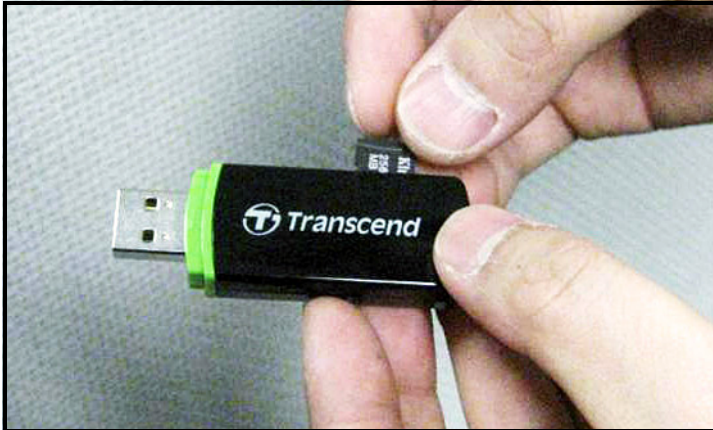
Figure 52: Einsetzen der MicroSD-Karte in ein Kartenlesegerät
