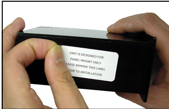
Figure 9: Entfernen des seitlichen Aufklebers für die Tafelmontage
