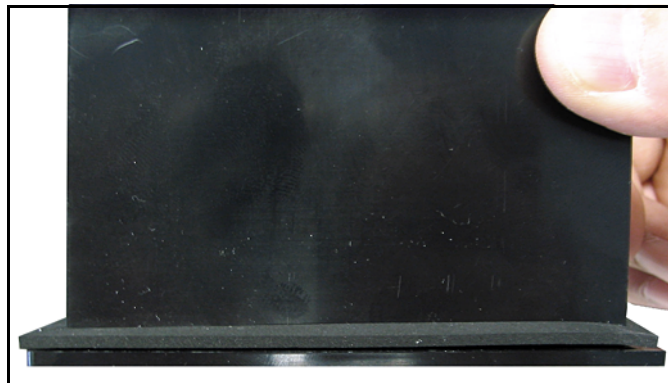
Figure 10: Anbringen der Dichtung hinter der Anzeige
