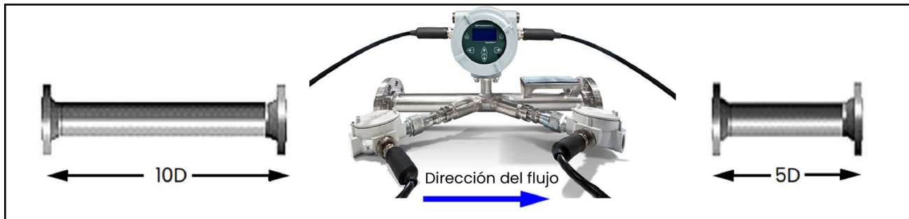
Figura 9: Requisitos mínimos para tuberías rectas
