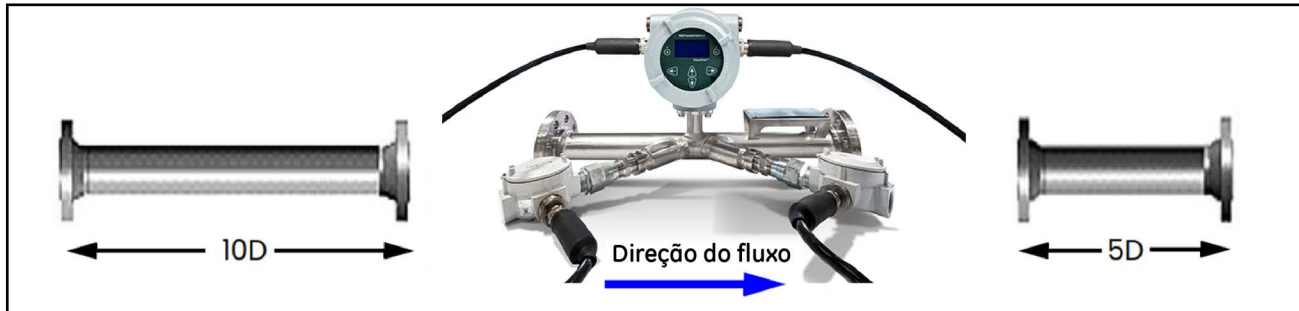
Figura 9: Requisitos mínimos para tubo de fluxo reto
