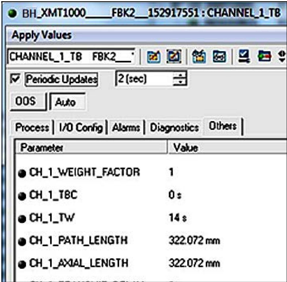
Figura 75: Bloco de Transdutor Composto
