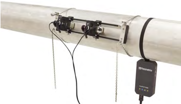
Aufspannvorrichtung, Messköpfe und Transmitter montiert auf einem Prozessrohr
