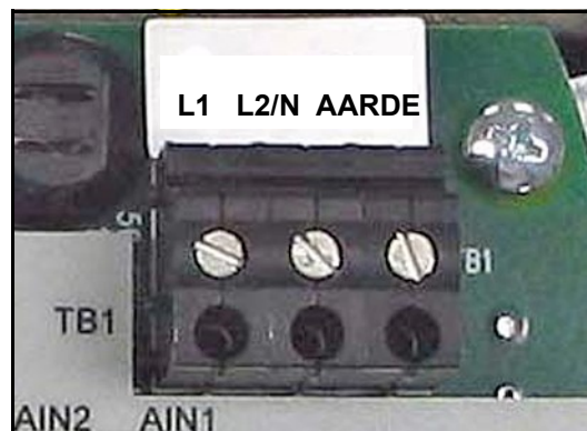
Figuur 20: Wisselstroomdraad aansluiten
