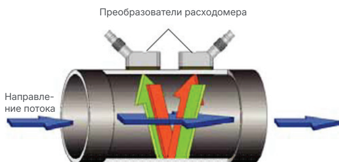
Путь ультразвукового сигнала преобразователей Времяимпульсная технология измерения расхода
