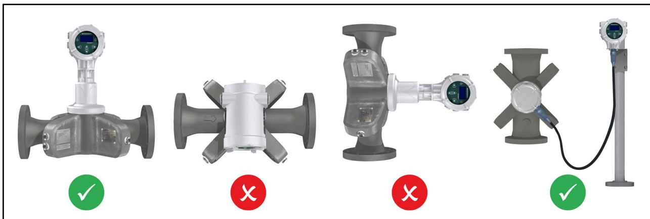
Рис. 10. Размещение преобразователей на горизонтальных/вертикальных трубопроводах
