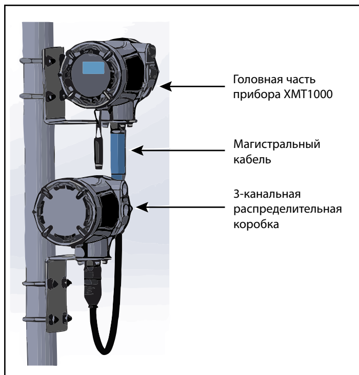
Рис. 29. Размещение магистрального кабеля ХМТ1000
