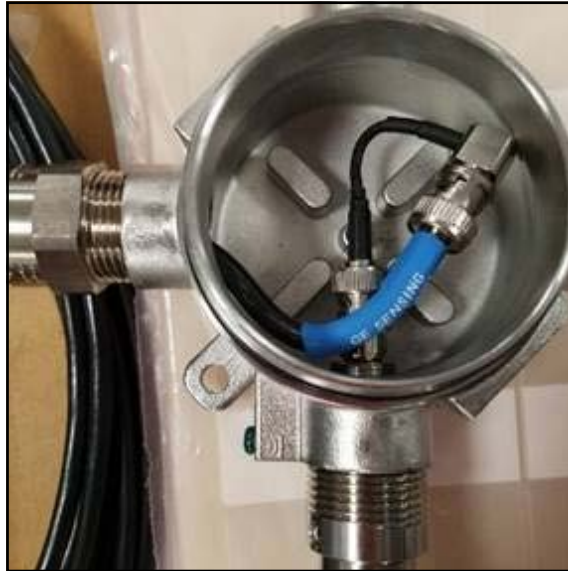
Figura 17: Conexão do Cabo do Transdutor com Jumper de Cabo, PN133M7313-03
