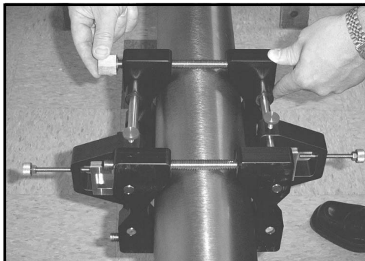
Figura 24: Instalando Porcas no Fixador
