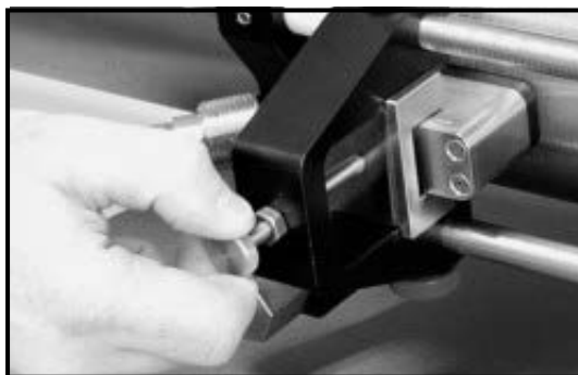
Figura 26: Instalando o Primeiro Transdutor
