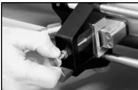
Figure 26 : Installation du premier transducteur
