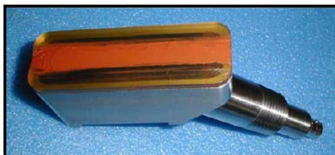
Figure 25 : Agent couplant sur un transducteur
