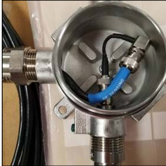
Figure 17 : Connexion de câble de transducteur avec cavalier, PN133M7313-03
