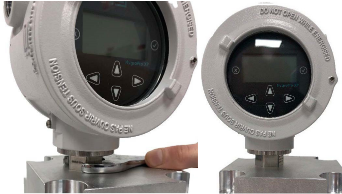
그림 6: HygroPro XP 설치 2단계 - 샘플 셀에 설치
