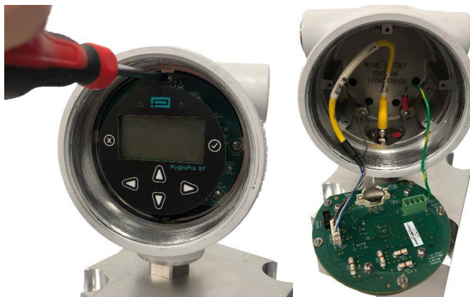
그림 8: HygroPro XP 설치 4단계 - HMI 풀기
