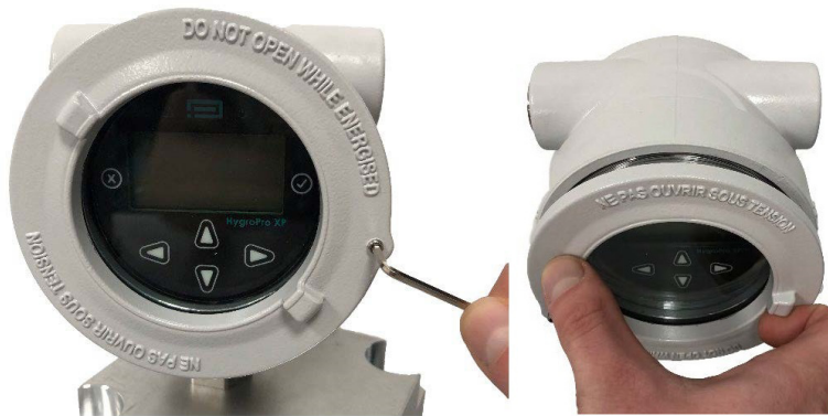
그림 7: HygroPro XP 설치 3단계 - 고정 나사를 풀어 인클로저 덮개 제거
