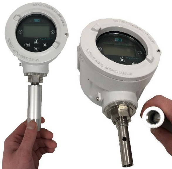
Figure 5 : Installation de l'HygroPro XP, étape 1 – retrait du bouchon déshydratant
