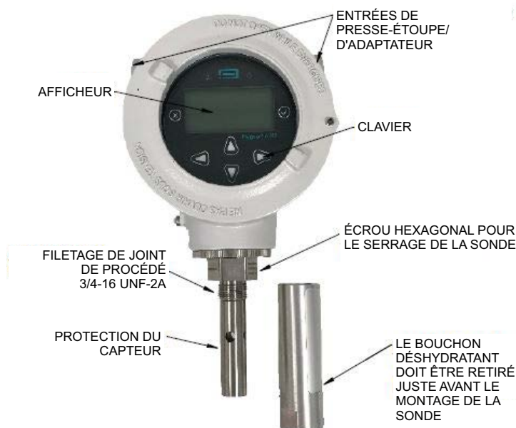
Figure 4 : Principales pièces de l'HygroPro XP relatives à l'installation
