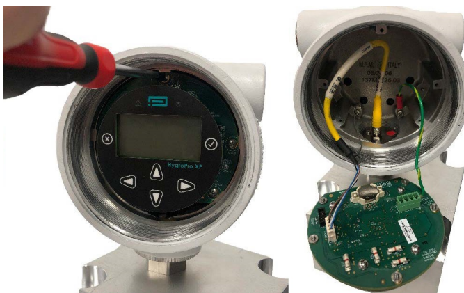
Figure 8 : Installation de l'HygroPro XP, étape 4 – retrait de l'IHM
