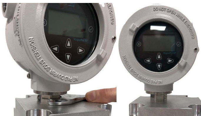
Figure 6 : Installation de l'HygroPro XP, étape 2 – installation dans la cellule d'échantillon
