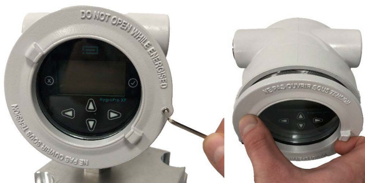
Figure 7 : Installation de l'HygroPro XP, étape 3 – desserrez la vis de réglage et dévissez le couvercle du boîtier
