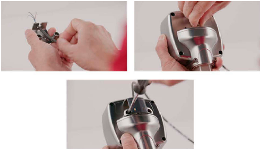
Рис. 4. Шаг установки HygroPro II 1 – первичный монтаж проводки
