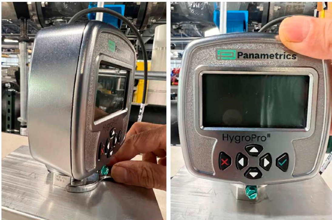
Рис. 6. Шаг установки HygroPro II 3 – установка в камеру отбора проб
