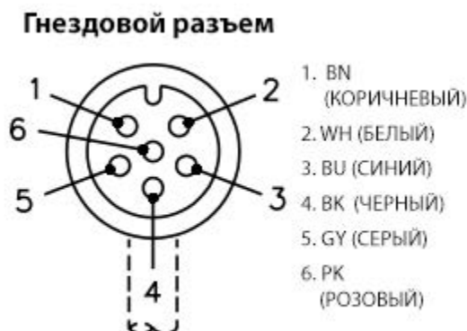
Рис. 21. Расположение 6 контактов гнездового разъема M8
