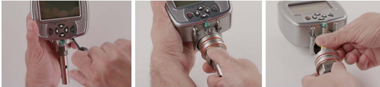
Рис. 17. Пошаговая процедура снятия зонда Hygro II RTE с анализатора
