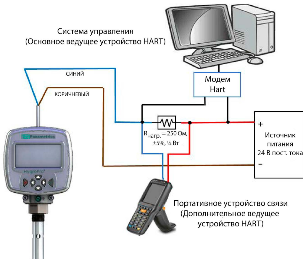
Рис. 8. Стандартное подключение к ведущим устройствам HART (портативное устройство и система управления заводом)
