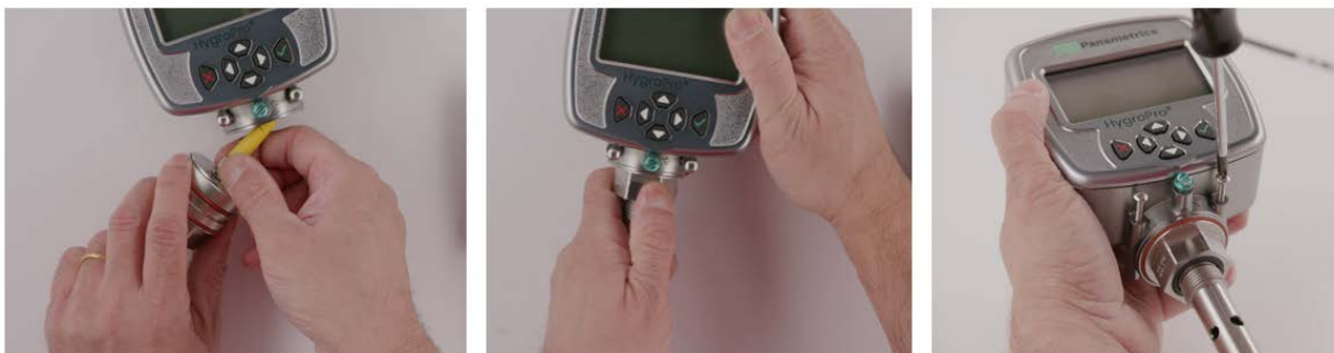
Рис. 19. Установка зонда Hygro II RTE на снятый анализатор
