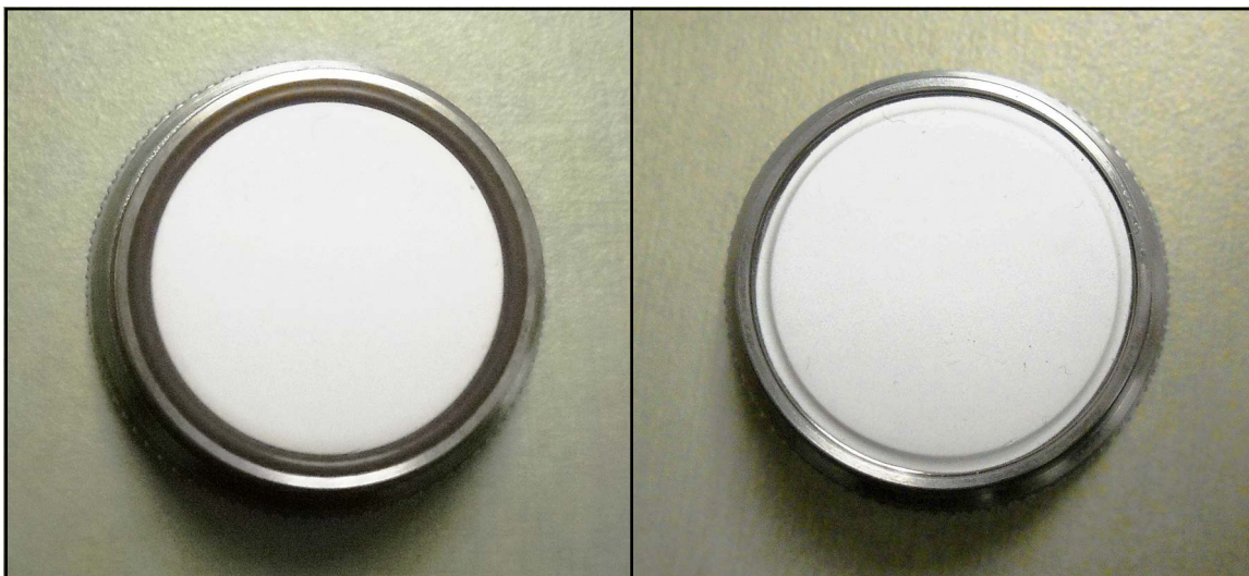
Rysunek 100: Zakrętka filtra prawidłowo zorientowana i po wyjęciu dużego pierścienia o-ring
