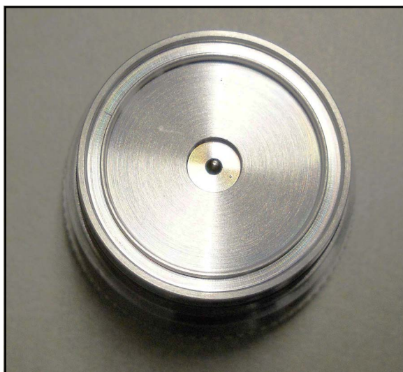
Rysunek 102: Po wyjęciu małego pierścienia o-ring
