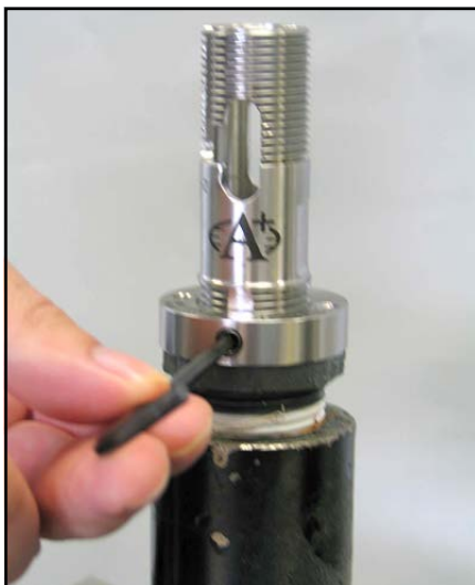
Rysunek 14: Wyrównywanie i dokręcanie wkrętu z łbem sześciokątnym
