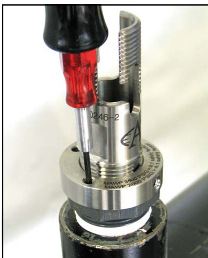
Rysunek 15: Dokręcanie wkrętów z łbem sześciokątnym
