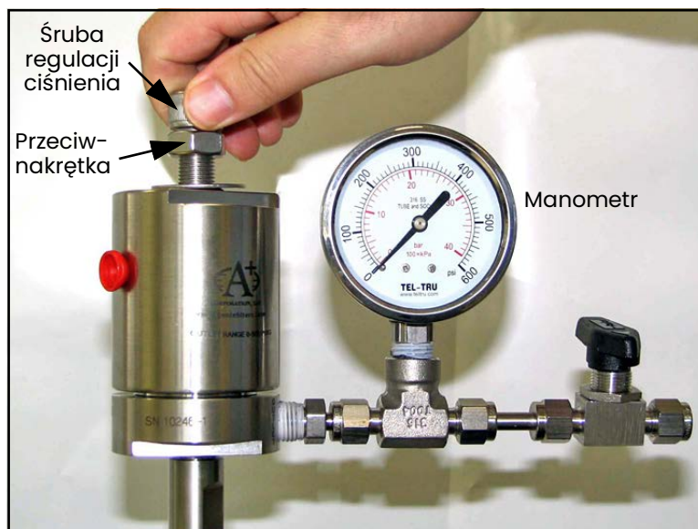
Rysunek 23: Obracanie śruby regulacji ciśnienia
