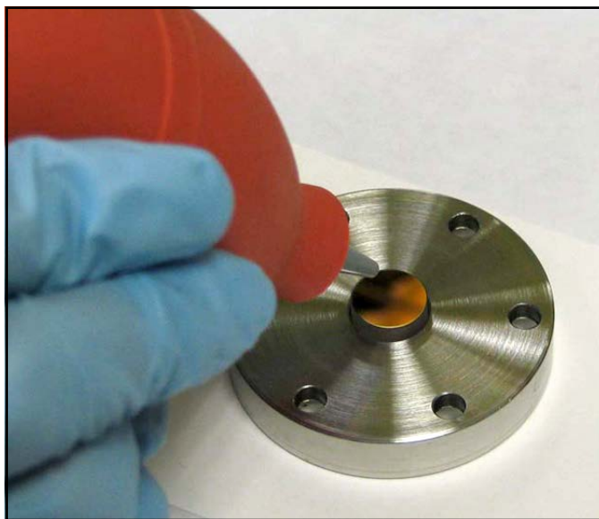
Rysunek 87: Wydmuchiwanie powietrza na lustro
