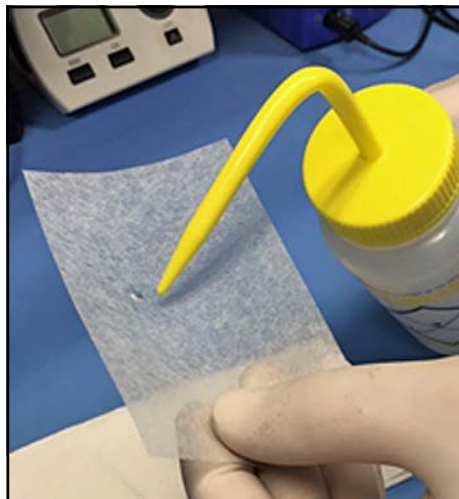
Rysunek 94: Nakładanie acetonu na chusteczkę do czyszczenia soczewek
