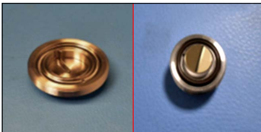
Rysunek 96: Umieszczanie wyczyszczonego lustra w zespole obsadki
