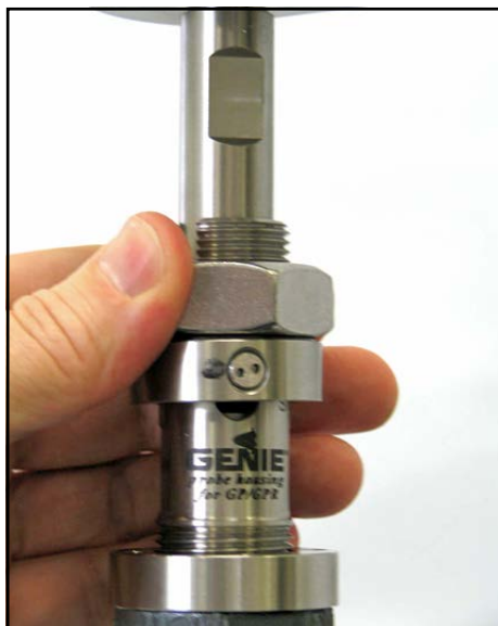
Rysunek 22: Dokręcanie nakrętki osadzanej
