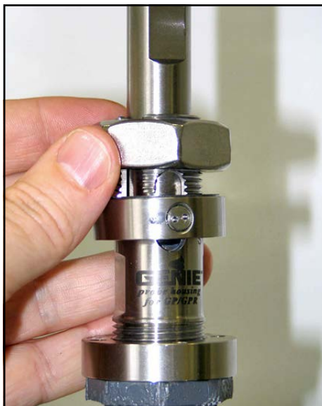
Rysunek 21: Luzowanie nakrętki osadzonej
