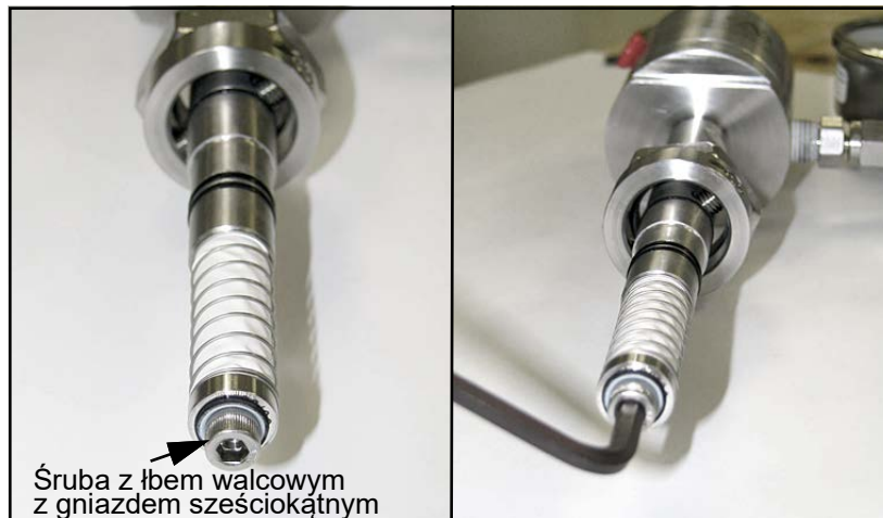
Rysunek 16: Sprawdzenie/dokręcanie śruby z łbem walcowym z gniazdem sześciokątnym
