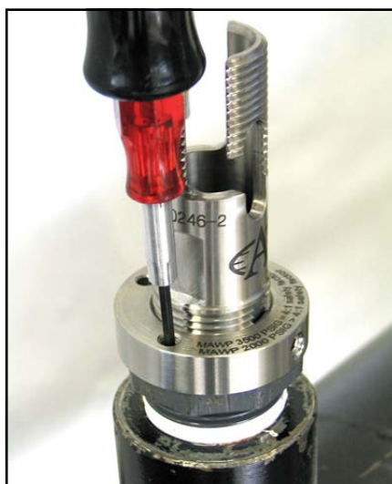
図 15: 六角穴付きねじの締め込み
