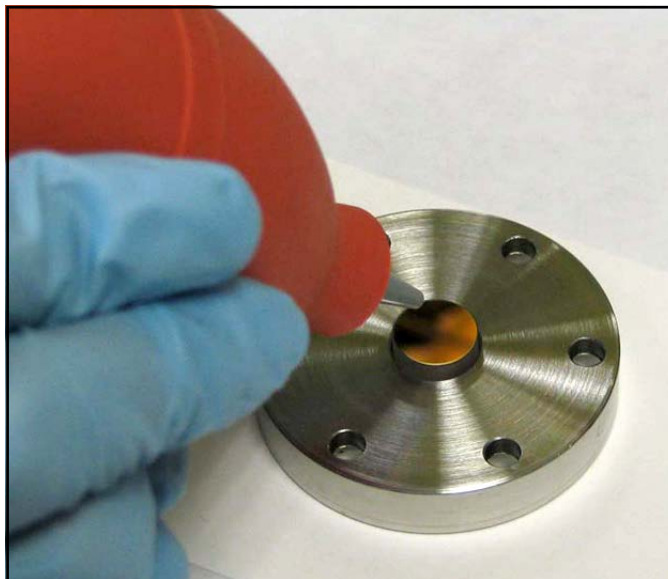
図 87: 鏡への空気の吹き付け
