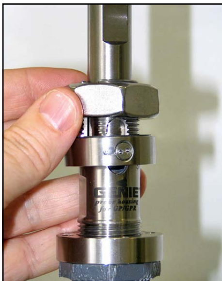
図 21: インサートナットを緩める
