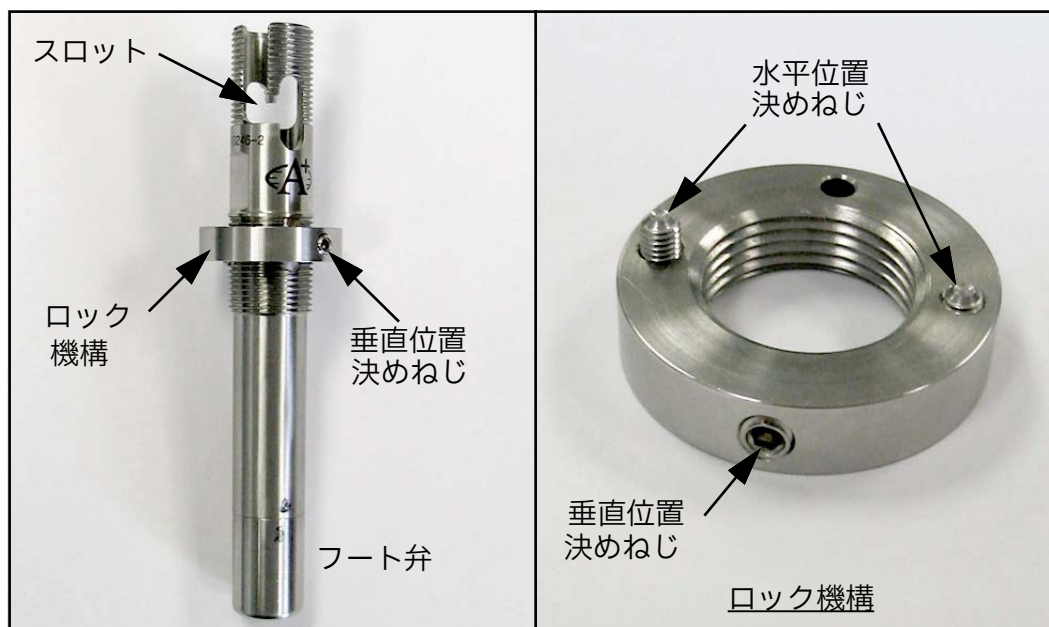
図 10: ハウジングとロック機構の取り付け
