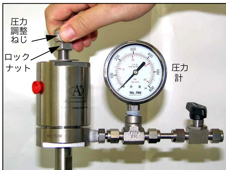
図 23: 圧力調整ねじを回す
