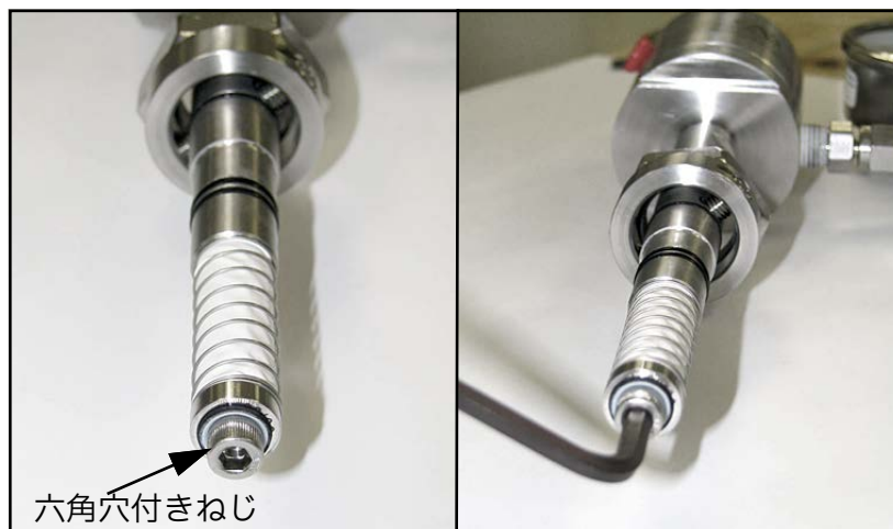
図 16: 六角穴付きねじの確認と締め込み
