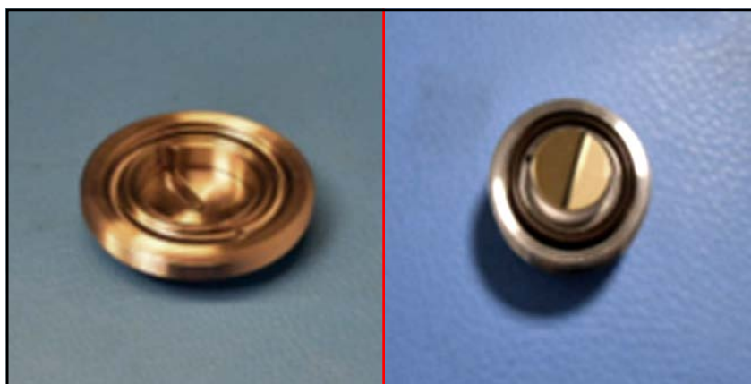
図 96: 清掃した鏡をエンドキャップアセンブリに戻す
