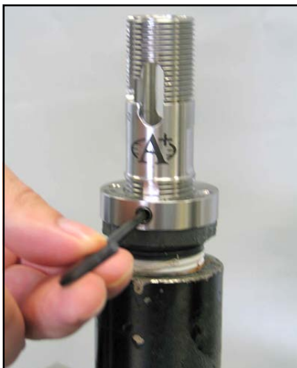
図 14: 六角穴付きねじの位置調整と締め込み
