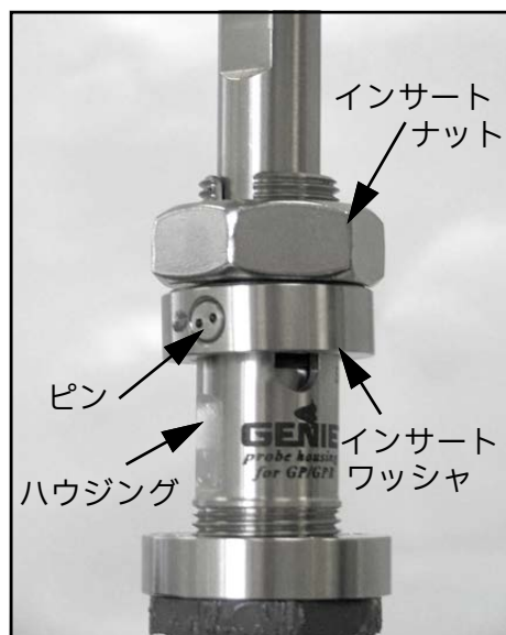
図 19: インサートナットのねじ込み
