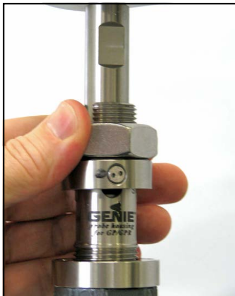
図 22: インサートナットの締め込み
