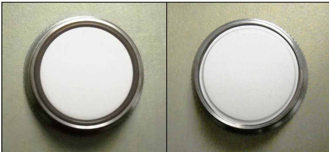
図 100: フィルタキャップの向きを合わせて、大きい O リングを取り外す
