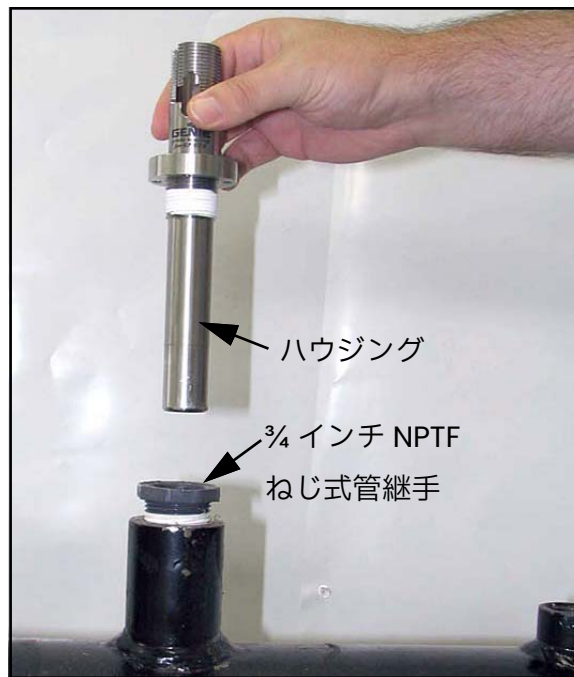
図 12: パイプラインへのハウジングの挿入
