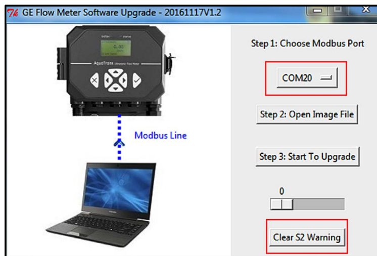
Рис 38: Очистка предупреждения S2
